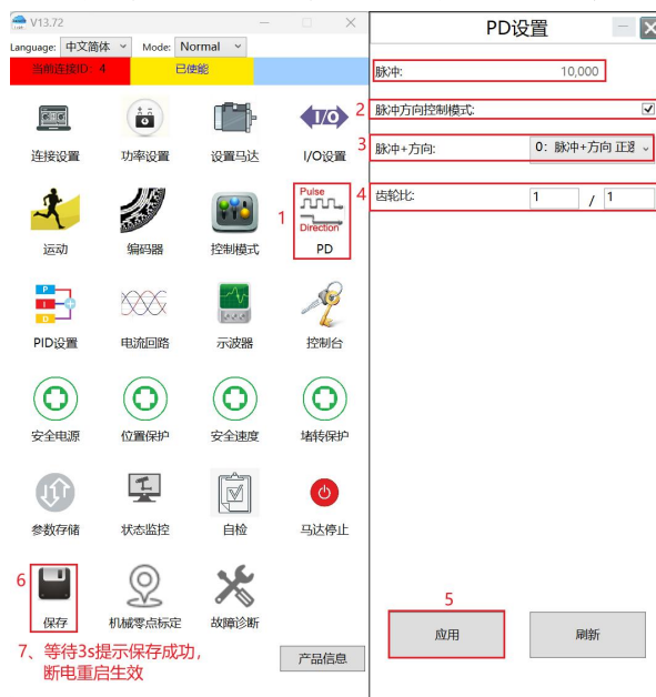
图 24-1 脉冲+方向控制参数配置
