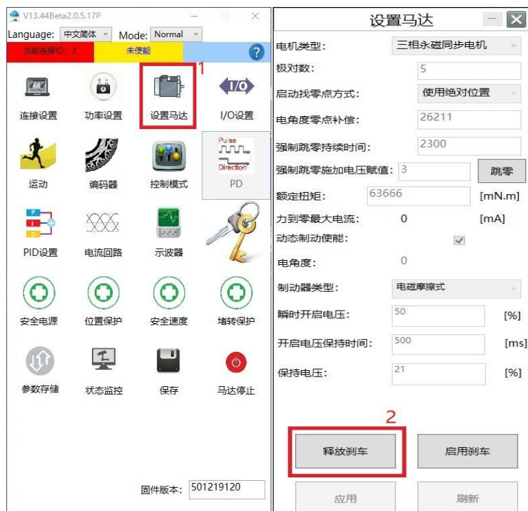
图 7-2 连接上位机释放制动器
