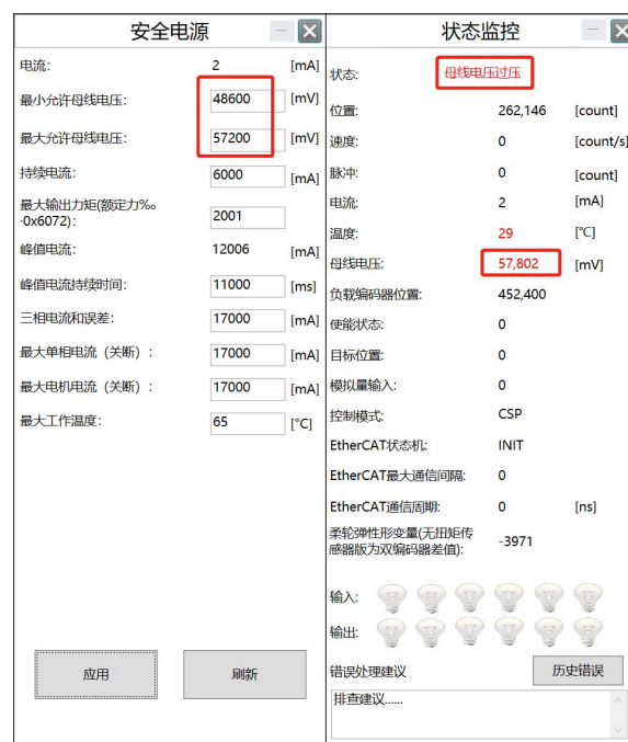
图 3-5 母线电压过压
