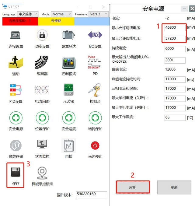
图 3-4 使用 52 V DC 电池供电电源设定举例
