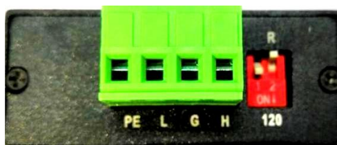
图 13-1 eRob 调试器接口图
