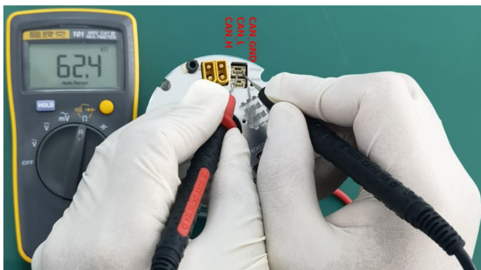
图 26-1 CAN 通信正常电阻测量值
