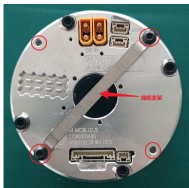
图 6-18 安装线缆支架
