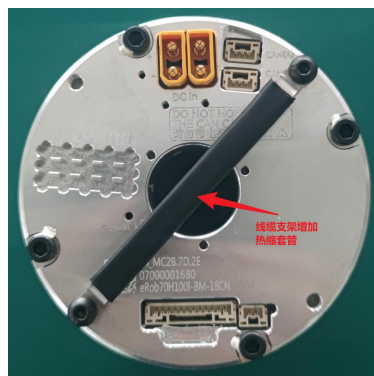
图 6-19 线缆支架增加热缩套管
