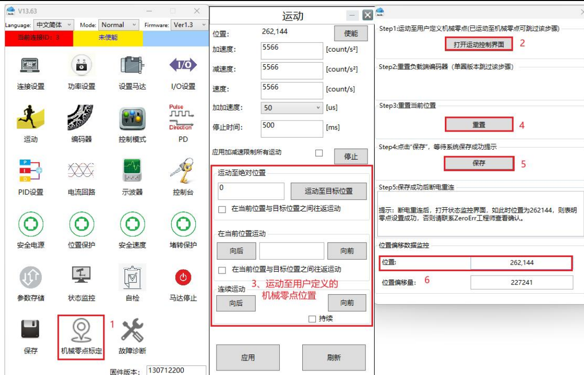
图 9-6 单圈关节机械零点标定功能
