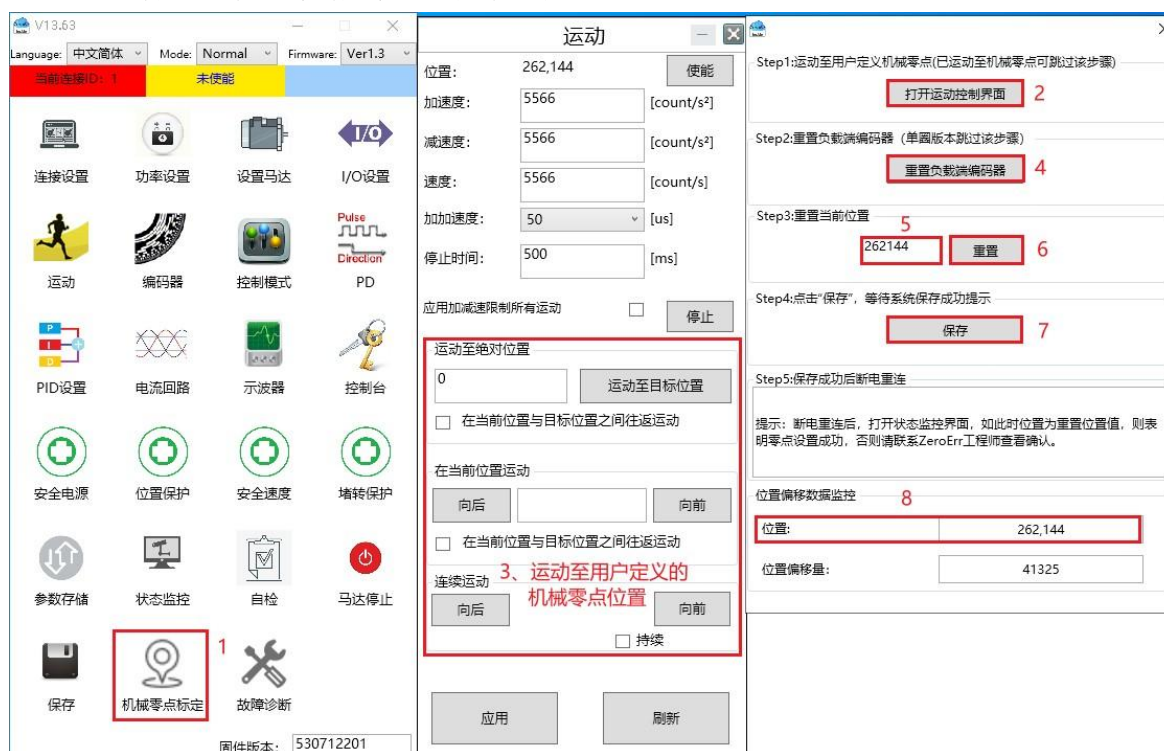
图 9-9 多圈关节机械零点标定功能
