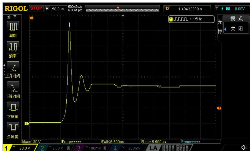
图 3-1 关节异常供电的输入电压波形 (Max=130 V>60 V)
