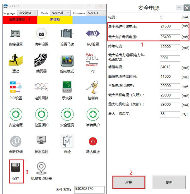
图 3-6 使用 24 V DC 供电电源设定举例
