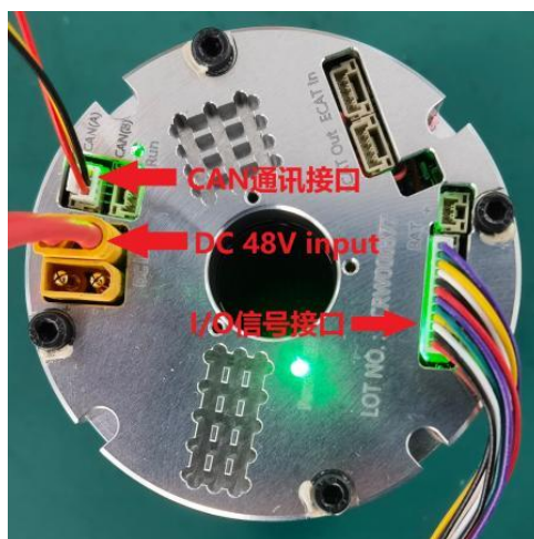
图 21-1 接线示意图
