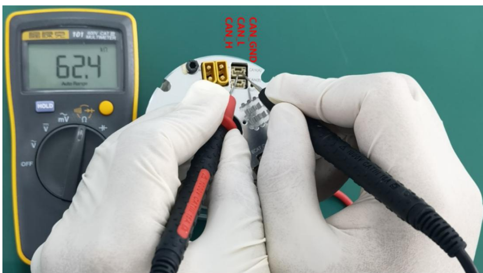
图 26-1 CAN 通信正常电阻测量值
