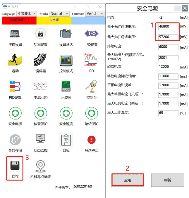
图 3-4 使用 DC52V 电池供电电源设定举例
