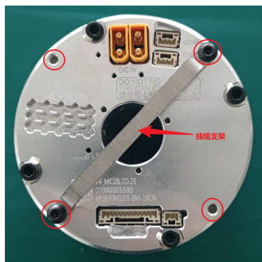
图 6-18 安装线缆支架
