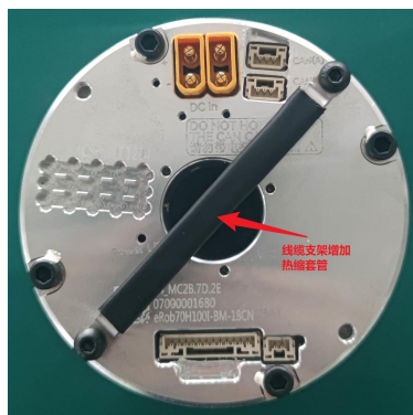
图 6-19 线缆支架增加热缩套管
